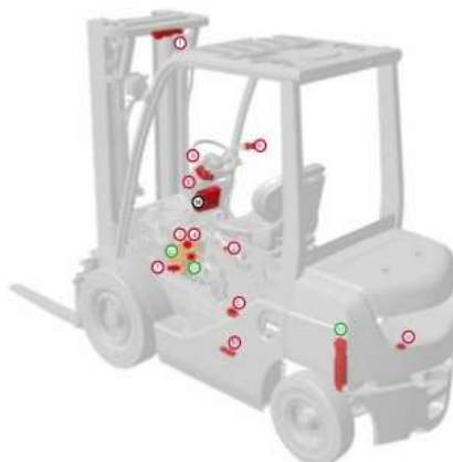
Slika 2. Raspored senzora, davača i kontrolera u SAS sistemu
