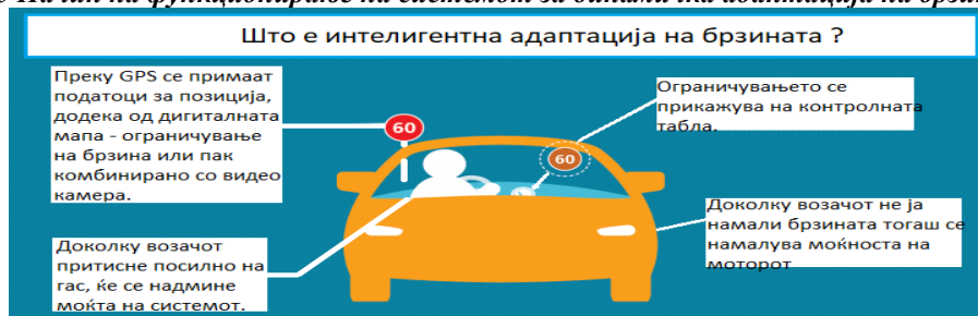
Сл.5 Начин на функционирање на системот за динамичка адаптација на брзината
