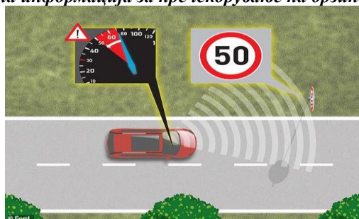
Сл.5 Начин на функционирање на системот за динамичка адаптација на брзината
