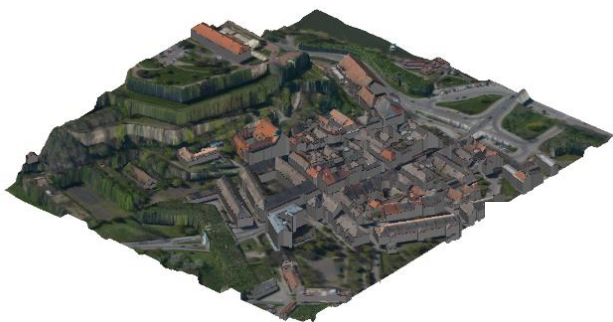
Slika 10 Rezultat kombinovanja LiDAR podataka i ortofoto snimaka
